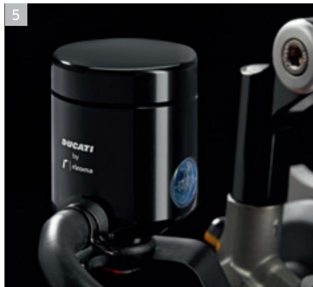
5 Serbatoio liquido freno - Serbatoio liquido frizione
